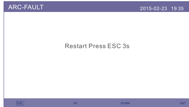
Figura 6.55 Guasto da arco elettrico
